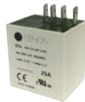
Die **Elektronische** Anlaufsteuerung Typ DT ist ein analoges Bauteil, das dem einphasigen Elektromotor beim Anlaufen hilft, indem es den Anlaufkondensator zu dem Betriebskondensator zuschaltet und wieder abschaltet, wenn der Motor seine Geschwindigkeit erreicht hat.
