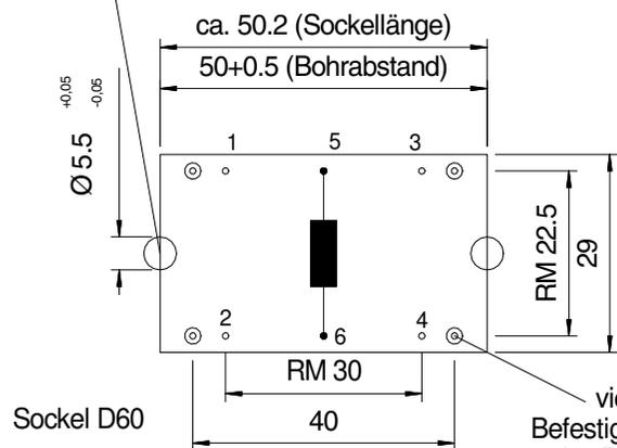
vier zusätzliche Befestigungsmöglichkeiten des Bauteils mit Blechschraube (z.B.:2.2x6.5)
